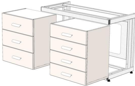
Рис. 1. Установка высоких тумб на каркас
